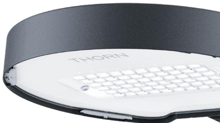
Carat a été conçu pour résister à l'épreuve du temps. Ce luminaire incroyablement résistant est fabriqué dans des matériaux d'une qualité exceptionnelle. Le corps en fonderie d'aluminium de qualité EN AC-44300 est compatible de série avec les environnements côtiers. Combiné avec des vis en acier inoxydable revêtues de zinc, ce luminaire atteint la catégorie C5, conformément à la norme EN ISO 9223.
