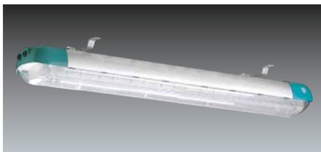
Petrelux 9 är en av våra lysrörsarmaturer som är ATEX certifierad och tillåten i zon 1 och 2 med temperaturgränserna T4 och T5.
